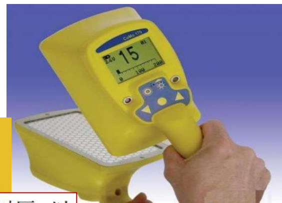
美国热电FH40G型多功能 X-γ辐射测量仪
